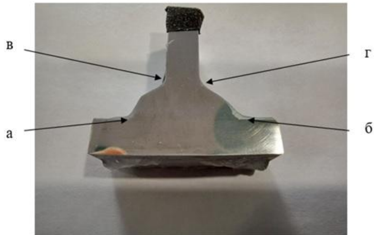
Рисунок 8.5 – Фрагмент сварного шва на образце с цинковым покрытием:
