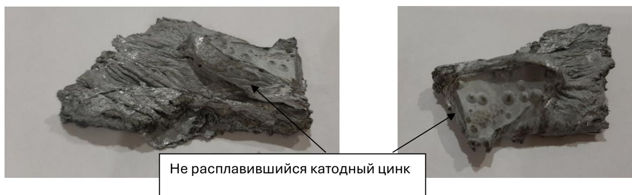
Рисунок 8.10 – Образец пены с фрагментом катодного цинка
