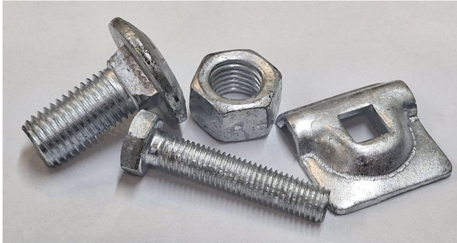
Рисунок 5.25 – Zn-(5÷7) масс. % Al покрытие на изделиях, общий вид.
