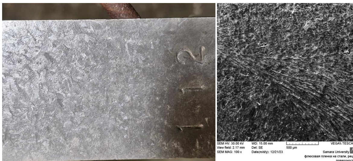
Рисунок 5.9 - Внешний вид сухой пленки флюса, содержащего 5 масс. % \text{SnCl}_2 , на поверхности стали
