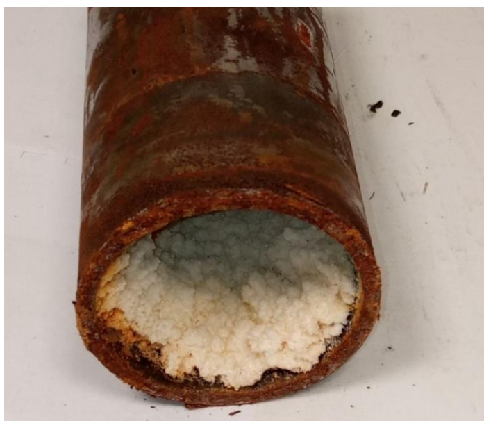
Рисунок 1 – НКТ 73 с солеотложениями гипсового типа
