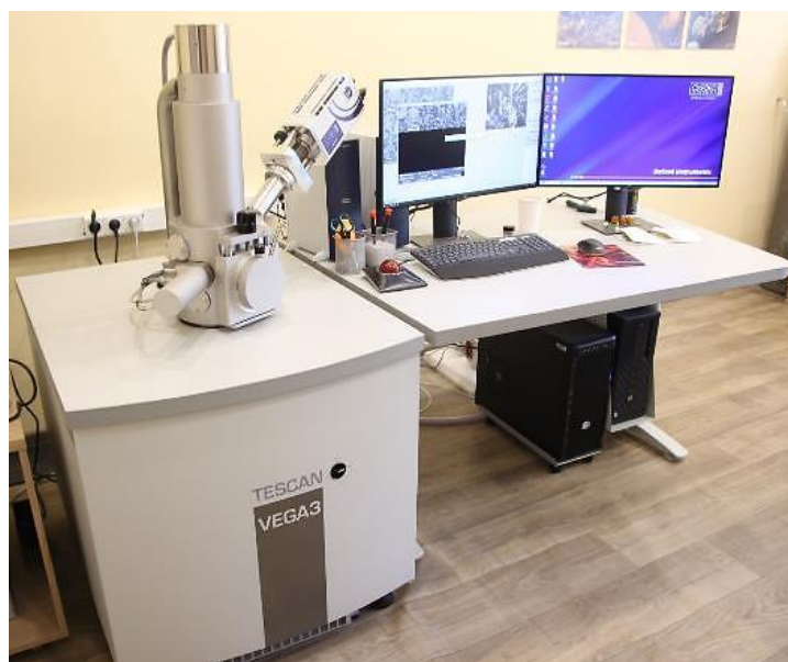
Рисунок 17 – Внешний вид растрового электронного микроскопа TESCAN VEGA3 с приставкой энергодисперсионного анализа X-Act
