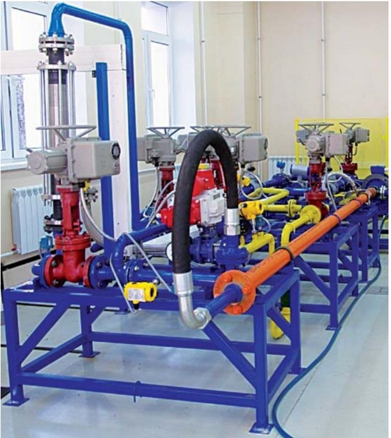
Рисунок 28 – «Стенд для моделирования отложений солей на рабочих органах ЭЦН и их элементах»
