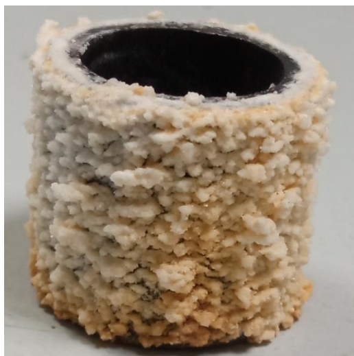
Рисунок 43 – Цилиндрический образец после проведения динамического испытания
