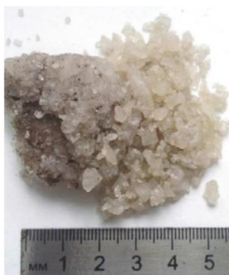
Рисунок 4 - Хлорид натрия (галит) отобран с поверхности насосно-компрессорных труб скважина 11 Карташовского месторождения
