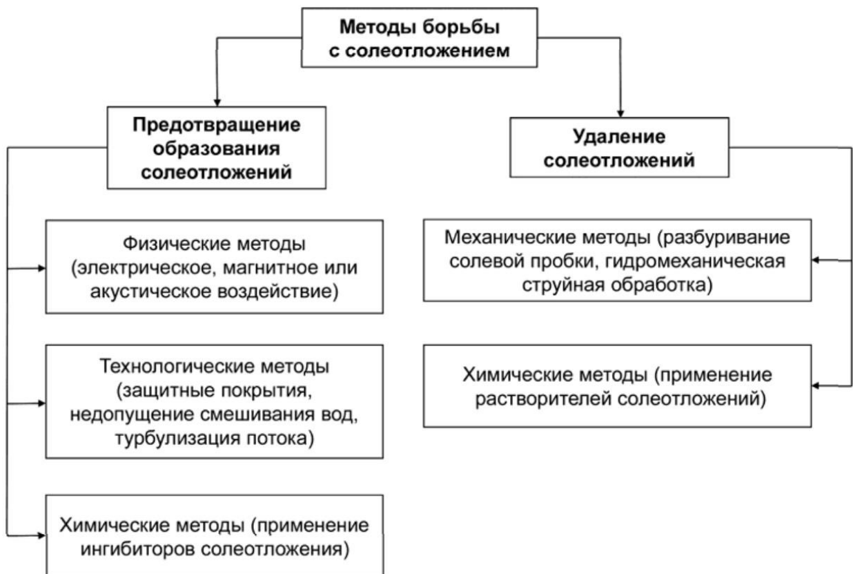
Рисунок 10 - Методы борьбы с солеотложениями, применяемые при добыче нефти [38]
