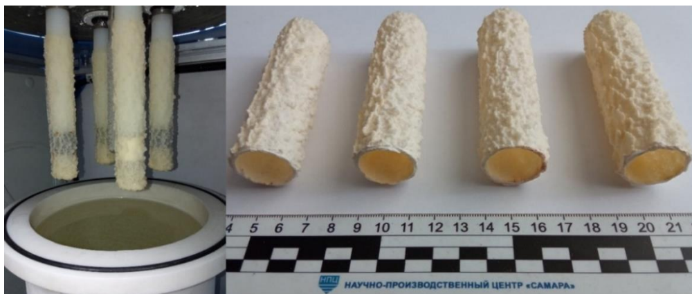
Рисунок 59 – Солеотложения, снятые с валов «Стенда оценки стойкости покрытий к неорганическим солеотложениям»
