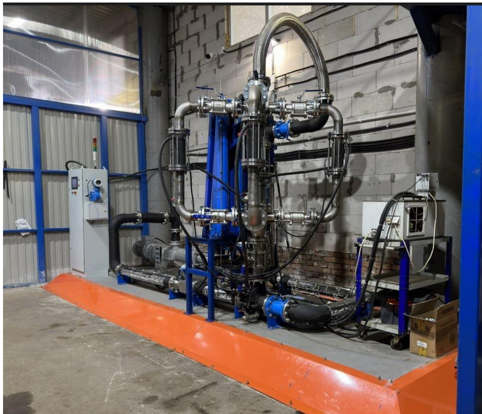
Рисунок 22 – Испытательный циркуляционный стенд АСПО, разработанный в ООО «НПЦ «Самара»
