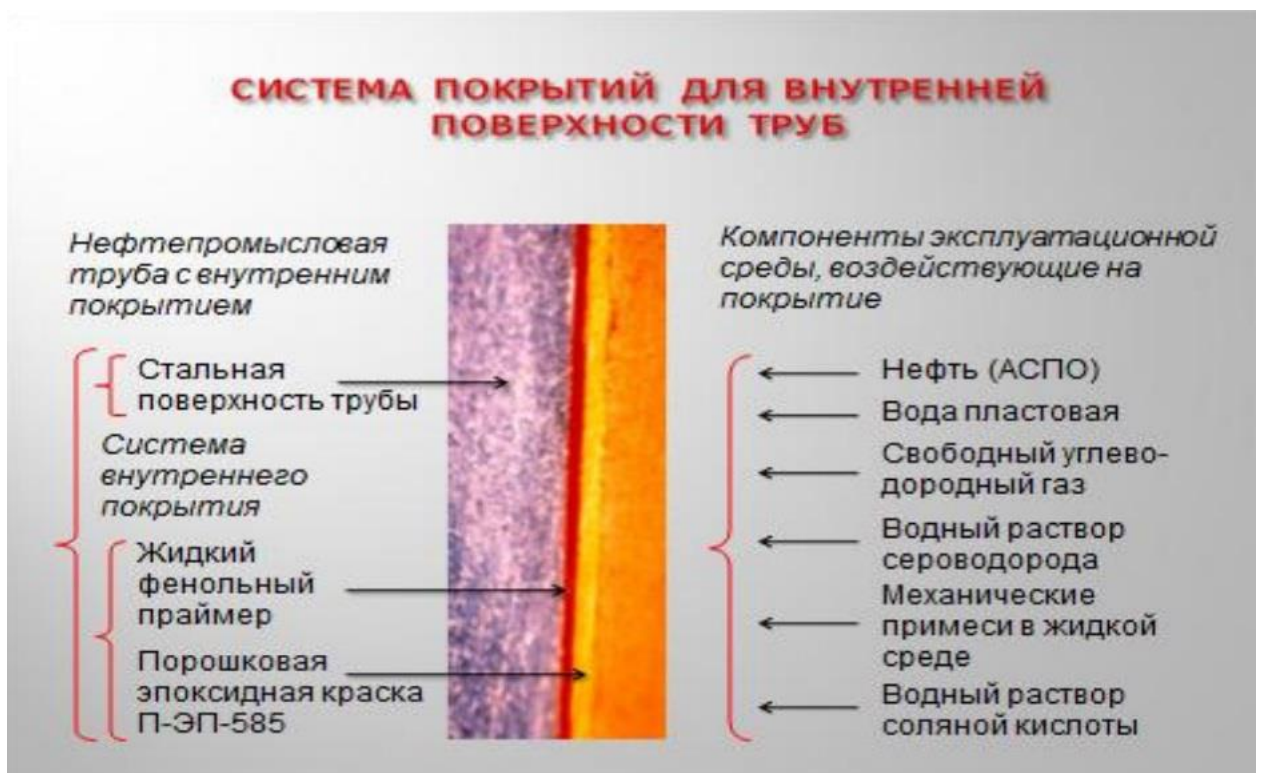
Рисунок 13 – Система покрытий для внутренней поверхности труб
