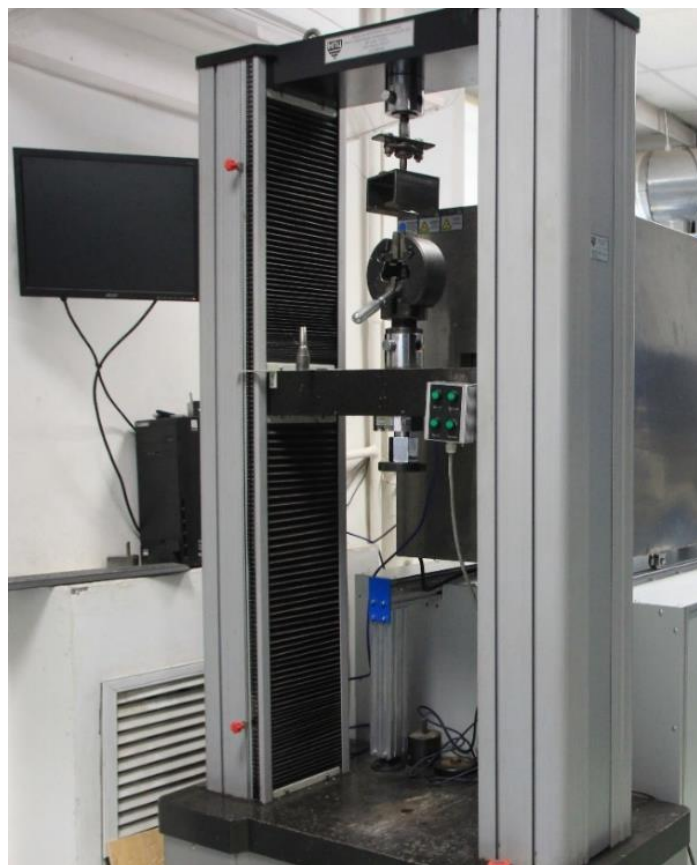
Рисунок 20 – Машина испытательная электромеханическая WDW-100E
