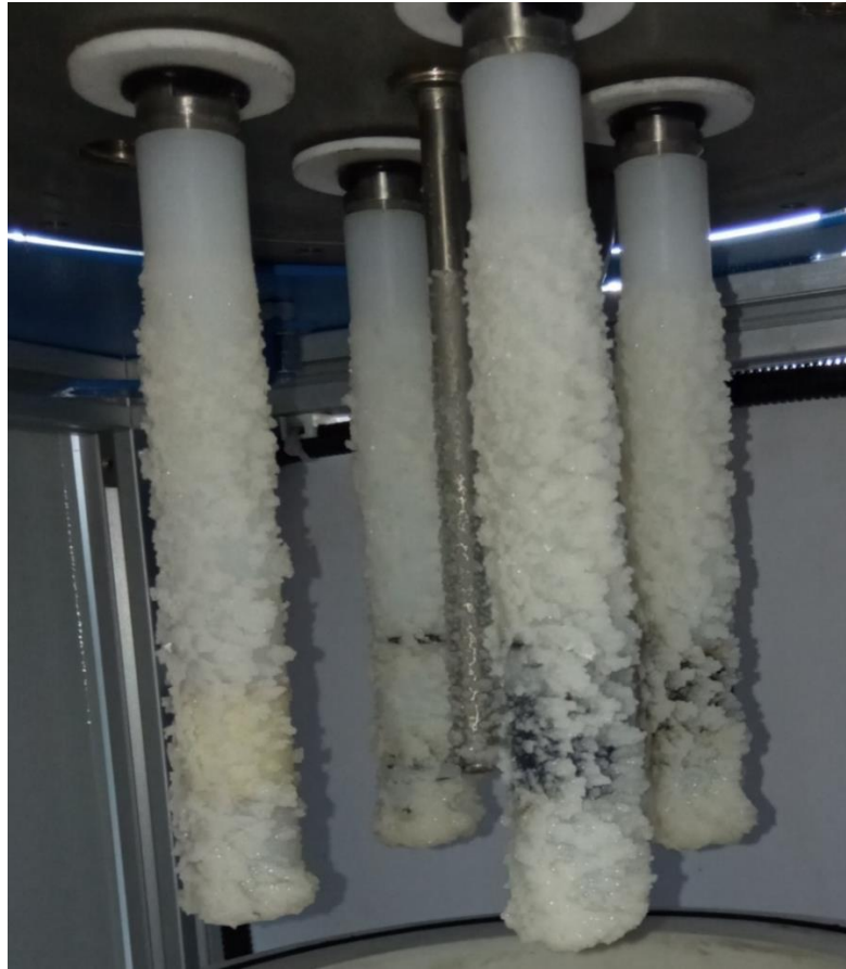
Рисунок 76 – 100 об/мин. Эквивалент линейной скорости движения потока 0,1 м/с
