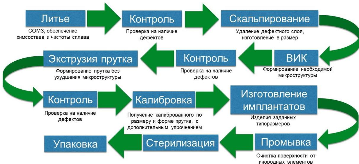
Рисунок 14 – Технологическая цепочка изготовления биорезорбируемых имплантатов
