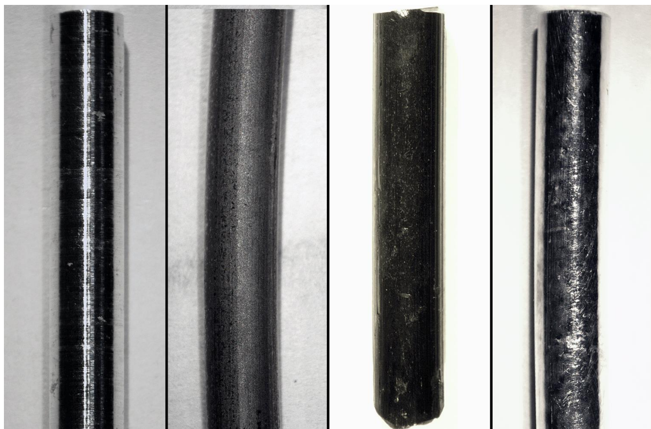
Рисунок 5.11 – Внешний вид образцов: а) ВИК после токарной обработки; б) Экструдированная проволока; в) После плавиковой кислоты; г) После ЭПП.
