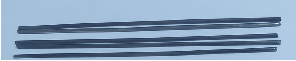
Рисунок 5.6 – Экструдированные прутки на диаметр 2,7 мм
