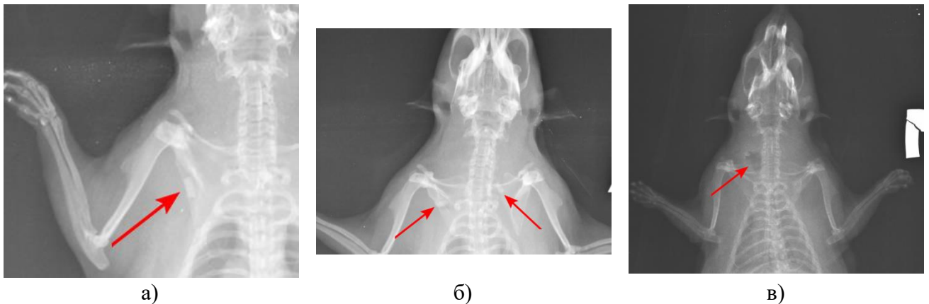
Рисунок 3.17 – Рентгенограмма лопатки крысы в прямой проекции с образцами сплавов, указанными стрелками: а – S11-VIK11, б – S11-VIK1P, в – S3-VIK3
