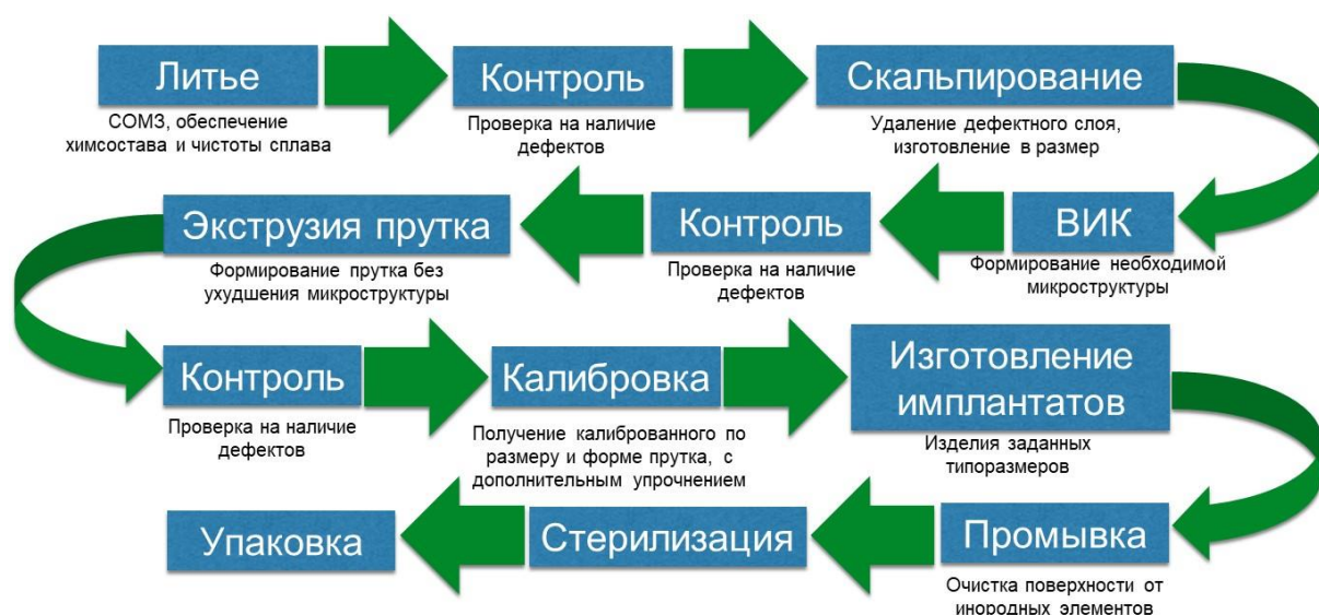
Рисунок 5.1 – Технологическая цепочка изготовления биорезорбируемых имплантатов
