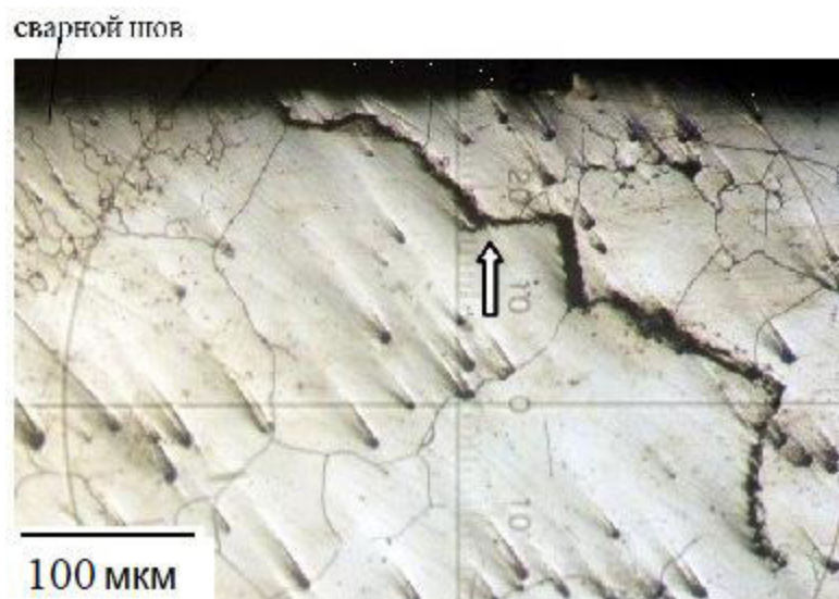
Рисунок 6.4 – Трещина в ЗТВ, выходящая к границе сварного шва сплава ЭП718
