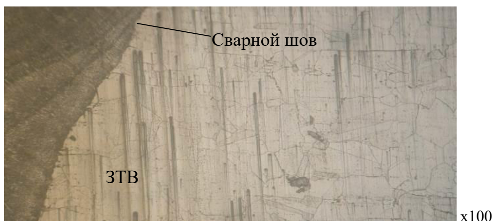
Рисунок 3.17 – Зеренная структура сварного соединения после ЭЛС при режиме № 23 (таблица 3.2)
