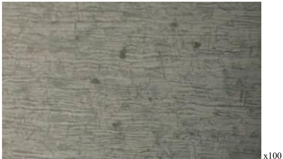
Рисунок 3.18 – Зеренная структура шва после ЭЛС натурального узла при режиме № 23 (таблица 3.2)
