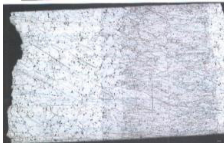
Рисунок 6.27 – Микроструктура образцов из сплава ЭП718 (режим испытания № 22) в зоне разрушения
