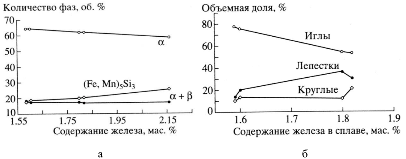
Рисунок 3 – Зависимость структурных характеристик латуни ЛМЦАЖКС от содержания железа: а) объёмная доля фаз [22]; б) объёмная доля силицидов различной морфологии [85]
