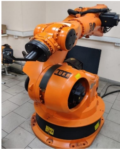
Рисунок 19 – Промышленный робот-манипулятор KUKAKR210-2 2000 с установленной TIG-горелкой для реализации ЭДПМ
