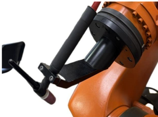
Рисунок 20 – Специальная оснастка для фиксации сварочной горелки TIG при выполнении ЭДПМ.
