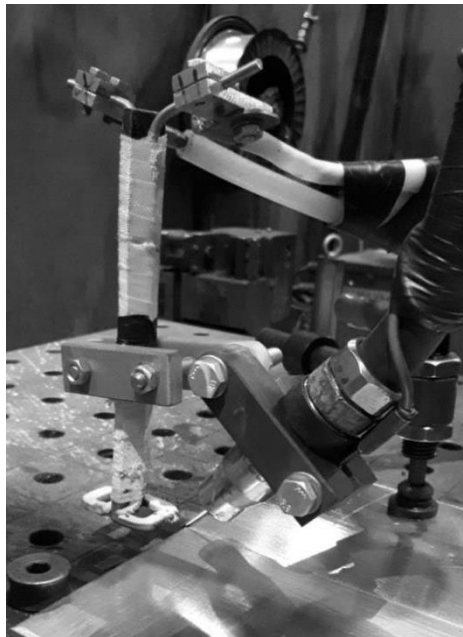
Рисунок 41 - Совмещение индуктора и сварочной горелки относительно наплавляемого слоя
