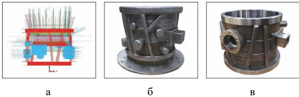
а - заготовка после 3D-печати, б, в – готовый корпус редуктора
