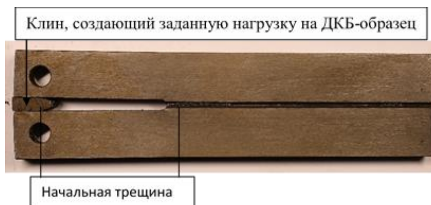
Рисунок 2.6 – Образец ДКБ, нагруженный клином
