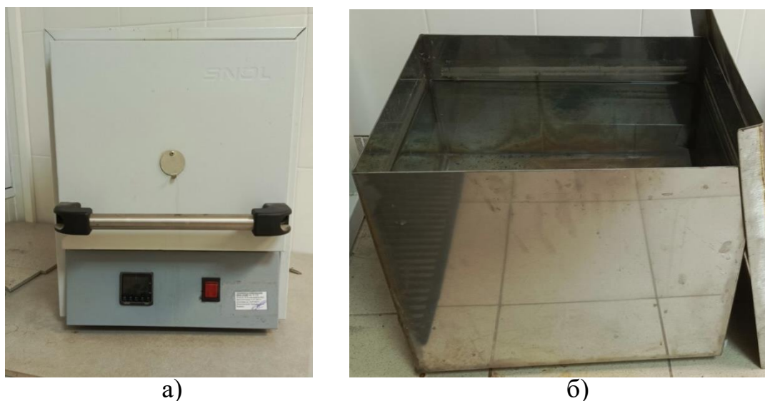
Рисунок 2.1 – а - Внешний вид электропечи сопротивления SNOL 3/1100 и закалочного бака с водой (б).
