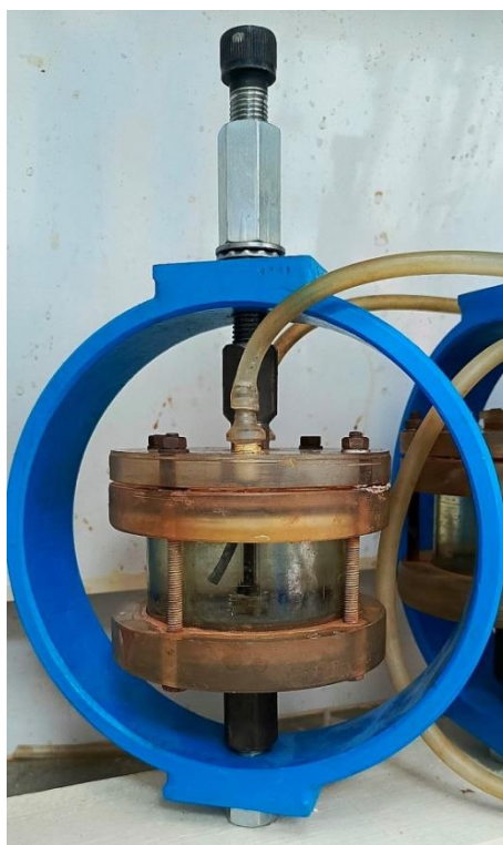
Рисунок 2.5 – Установка «Cortest» для проведения испытаний на стойкость к СКРН по стандарту NACE TM0177, метод А
