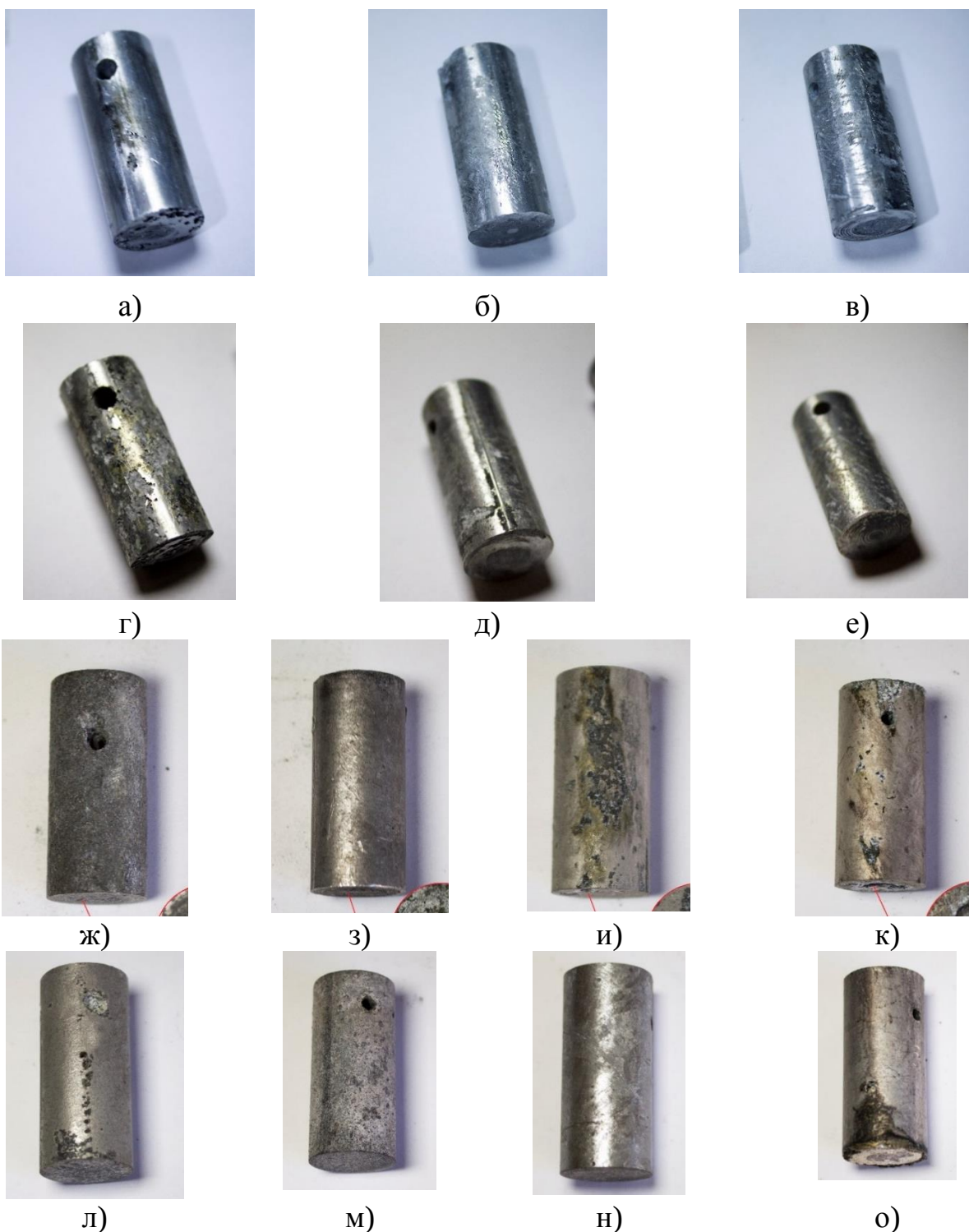
Рисунок 7.4 – Вид образцов после испытаний на коррозионную стойкость:
