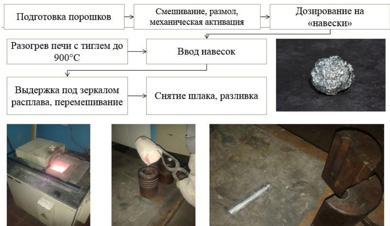
Рисунок 2.3 - Общая схема изготовления композиционных материалов системы Al-TiC методом СВС в расплаве
