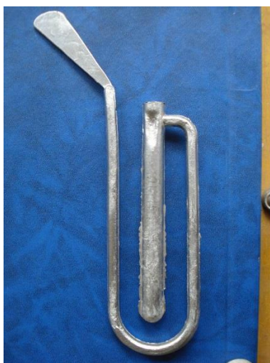
Рисунок 5.24 – U-образная проба композиционного материала АК7 - 6%TiC
