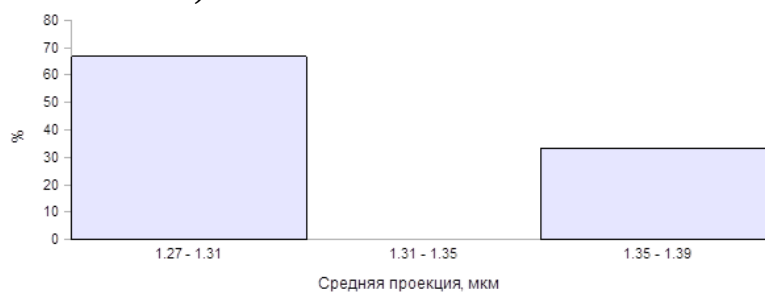
Рисунок 6.6 – Гистограммы распределения по размерам зерна \alpha -Al:
