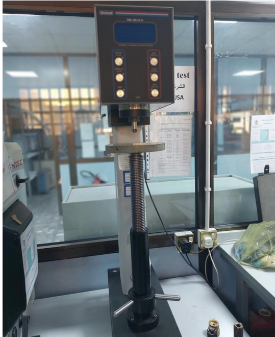
Рисунок 2.7– Определение твердости по Бринеллю
