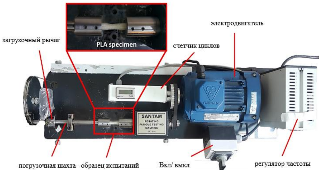
Рисунок 2.13 – Вращательно-изгибная машина для испытаний на усталость типа HI-TECH
