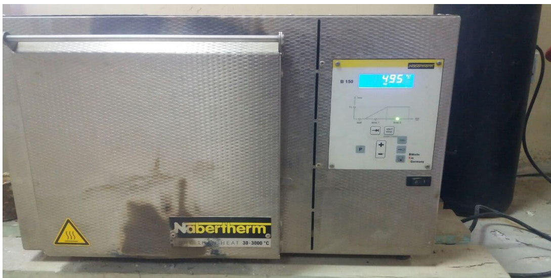
Рисунок 2.5 – Электропечь, используемая для термообработки и старения
