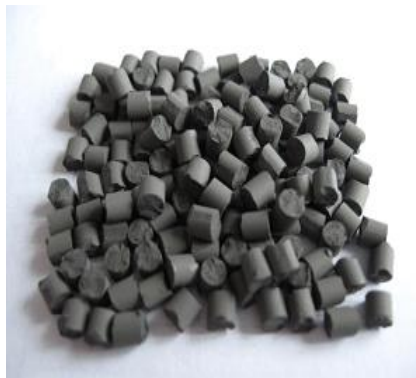
Рисунок 1 – Разработанный гранулят на основе порошка КЖ и ПФЛ
