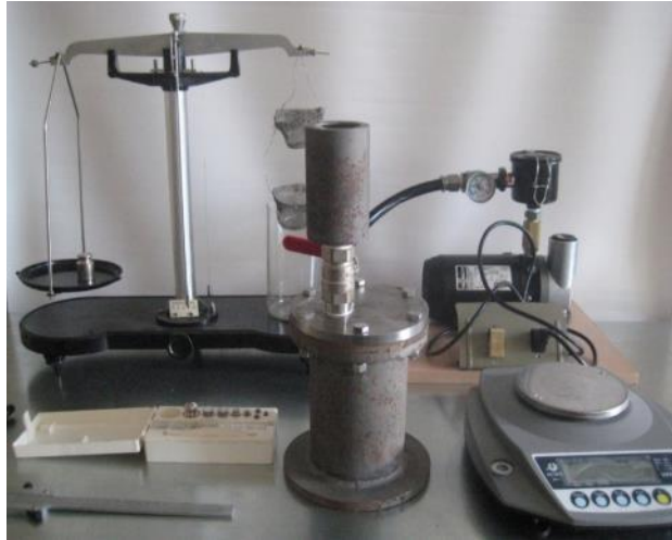
Рисунок 2.14 – Стенд для определения плотности и пористости гранул и спеченных из них деталей
