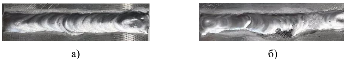
Рисунок 3.18 – Вид сварных швов образцов: а) АМг2; б) АМг2-10%ТiС
