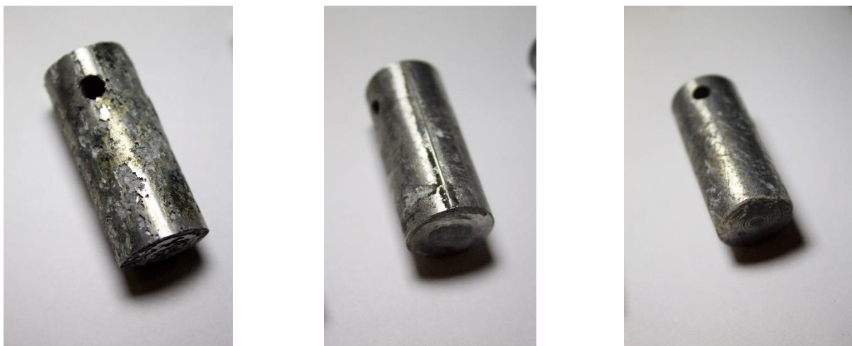
Рисунок 4.12 – Вид образцов после испытаний на коррозионную стойкость: а) АМг6Н; б) АМг6-10% TiC, без ТО; в) АМг6-10% TiC, нагрев 230°С 3 ч.
