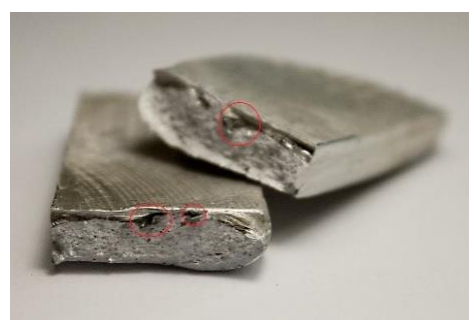
Рисунок 5.28 – Вид сварных соединений после испытаний на одноосное статическое растяжение: а) АМ4,5Кд; б) АМ4,5Кд-10% TiC
