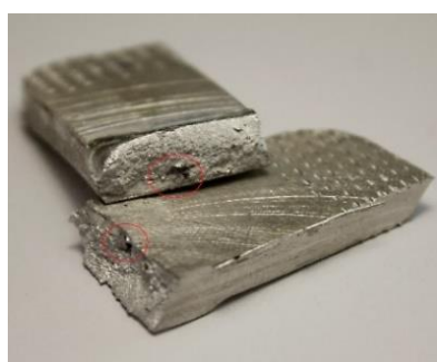
Рисунок 5.28 – Вид сварных соединений после испытаний на одноосное статическое растяжение: а) АМ4,5Кд; б) АМ4,5Кд-10% TiC
