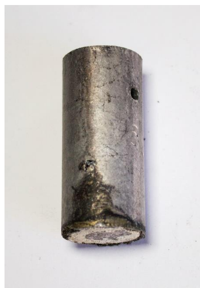
Рисунок 6.17 – Вид образцов после испытаний на коррозионную стойкость: а) АК10М2Н; б) АК10М2Н закалка 515°С 2 ч. + старение 190°С 2 ч.; в) АК10М2Н-10% TiC; г) АК10М2Н-10% TiC закалка 515°С 1 ч. + старение 190°С 2 ч.
