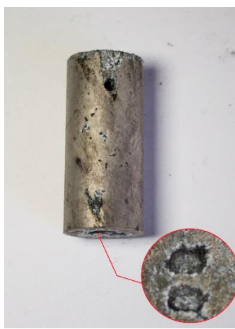
Рисунок 5.18 – Вид образцов после испытаний на коррозионную стойкость: а) AM4,5Кд; б) AM4,5Кд закалка 545°С 1 ч. + старение 170°С 6 ч.; в) AM4,5Кд- 10% TiC; г) AM4,5Кд-10% TiC закалка 545°С 1 ч. + старение 170°С 4 ч.
