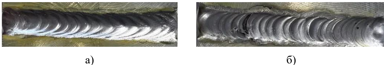
Рисунок 5.24 – Вид сварных швов образцов: а) АМ4,5Кд; б) АМ4,5Кд-10%ТiС
