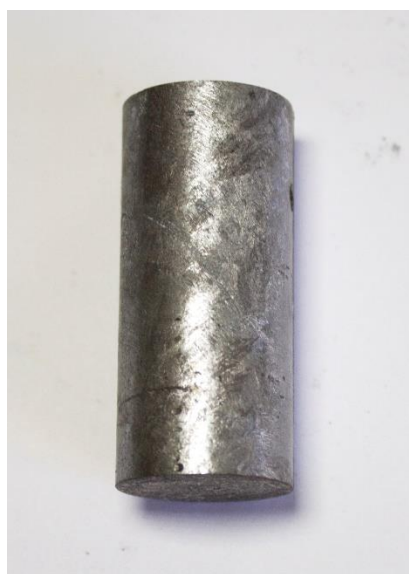
Рисунок 6.17 – Вид образцов после испытаний на коррозионную стойкость: а) АК10М2Н; б) АК10М2Н закалка 515°С 2 ч. + старение 190°С 2 ч.; в) АК10М2Н-10% TiC; г) АК10М2Н-10% TiC закалка 515°С 1 ч. + старение 190°С 2 ч.
