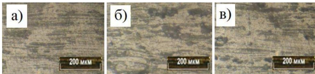
Рисунок 4.13 – Микроструктура сплава 5182 толщиной 0,25 мм после: а – холодной прокатки, б – после отжига на ЛНТО, в – после отжига в садочной печи,
